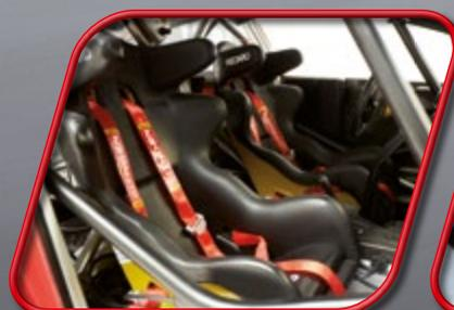
La estructura tubular interior, perfectamente detallada, protegía a los pilotos en caso de accidente y daba rigidez al C4 WRC.
