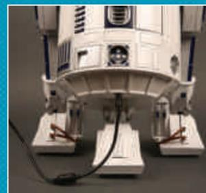
Im Inneren des Droidenkörpers befindet sich ein Batteriesatz für den Antriebsmotor, die Roboterfunktionen und die interne Elektronik. Zum Lieferumfang gehört eine Ladestation mit externem Anschluss. Sobald die Energie zur Neige geht, leuchtet ein Warnlicht auf. Es weist darauf hin, dass die Batterien (im Lieferumfang nicht enthalten!) wieder aufgeladen werden müssen.
